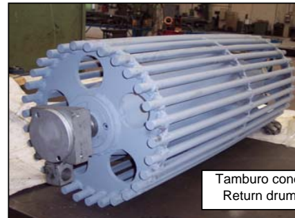
Aspo Rompitore Breaker shaft
